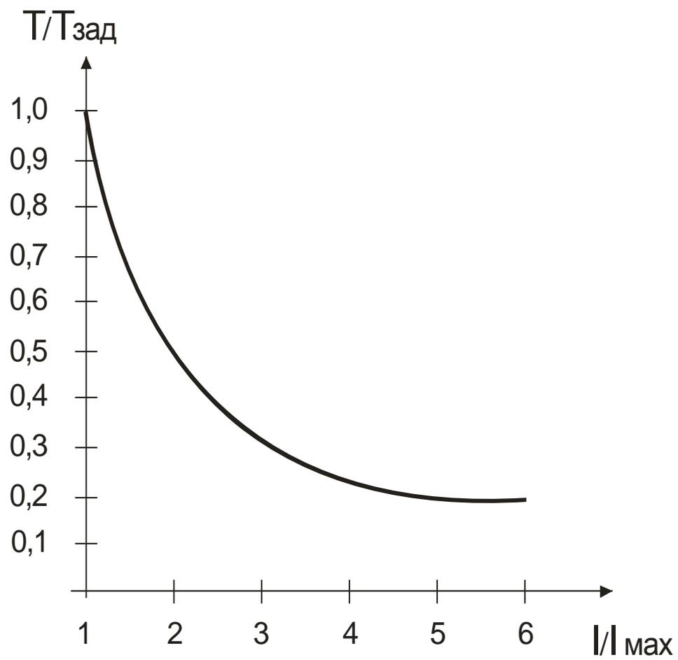
Рисунок 5 – токо-временная характеристика защитного отключения реле
